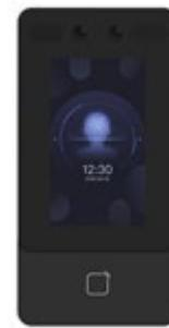
Терминал доступа ACT-T1342EW является терминалом доступа с функцией распознавания лиц. Терминал использует алгоритм глубокого обучения, который помогает быстрее и точнее распознавать лица. Он также поддерживает несколько режимов аутентификации: аутентификация по лицу / карте и т. д. Его можно применять в различных сценариях, таких как здания, предприятия, финансовые предприятия и другие важные объекты.
